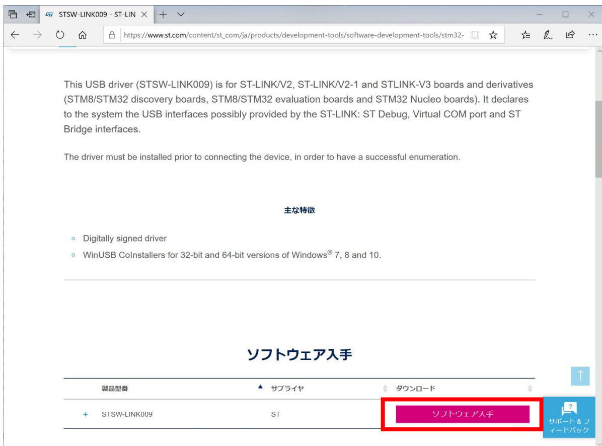
図 5.1-1 ST マイクロエレクトロニクス社サイトからの ST-LINK/V2 ドライバダウンロード
