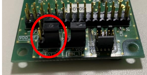
図 4-13 ブートローダ起動のためのジャンパ設定
