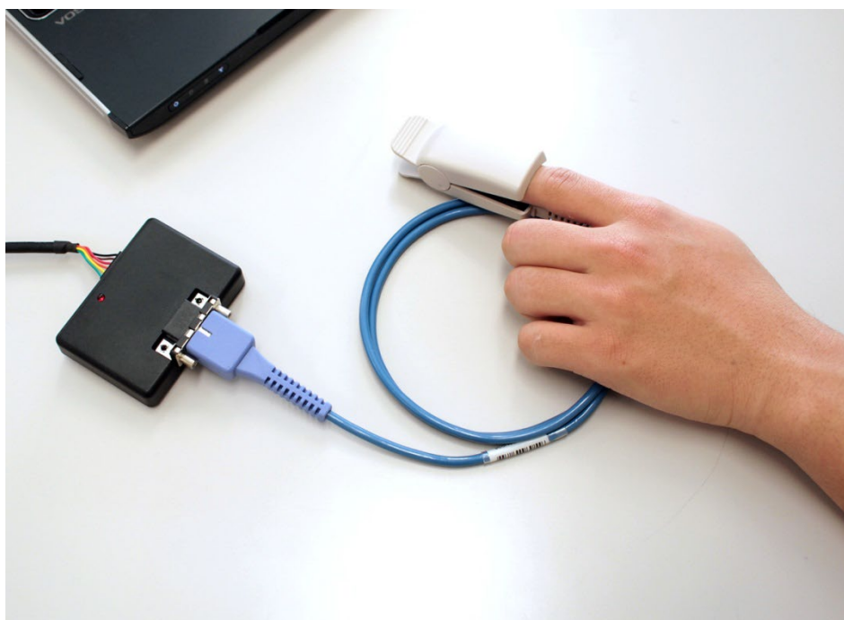
図 4 IWS920 本体と心拍プローブの接続
