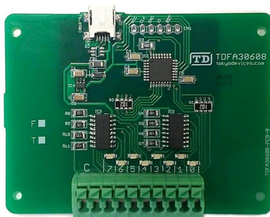
TDFA30608 は 8 チャンネルの接点を持つ USB デジタル IO 入力モジュールです。さまざまな外部機器からの信号を自分のプログラムから簡単に読み取ることができます。電氣的に絶縁されているため安全・耐ノイズ性に優れます。バスパワーで動作しますので USB 側には電源が不要です。
