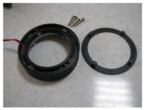
再度ふたを閉め支持ネジを通したとき座りが悪い場合は、ふたにある突起の位置を変更 して座りの良い場所を探してください。
